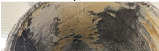
Εικόνα 1: Πείραμα δοκιμής προστατευτικού πολφού μαγνησίας σε επιφάνεια πραγματικού αγωγού αποχέτευσης.
