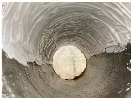
Εικόνα 1: Πείραμα δοκιμής προστατευτικού πολφού μαγνησίας σε επιφάνεια πραγματικού αγωγού αποχέτευσης.
